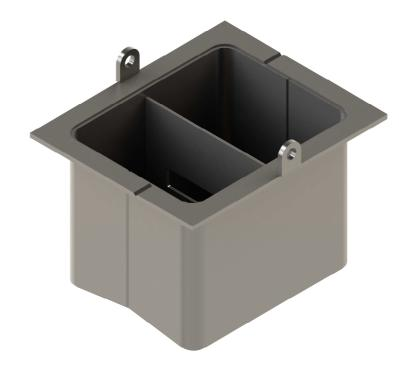
Der Magnesium Schmelztiegel 101-TG-800-T1 hat ein Fassungsvermögen von ca. 800kg und darf ausschließlich für Magnesium bzw. Magnesium Legierungen bis zu einem Al-Gehalt von 10,5% eingesetzt werden.
